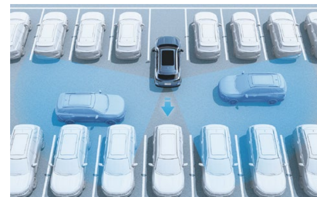
CTA 倒車來車警示系統 (附後方來車方向標示)
